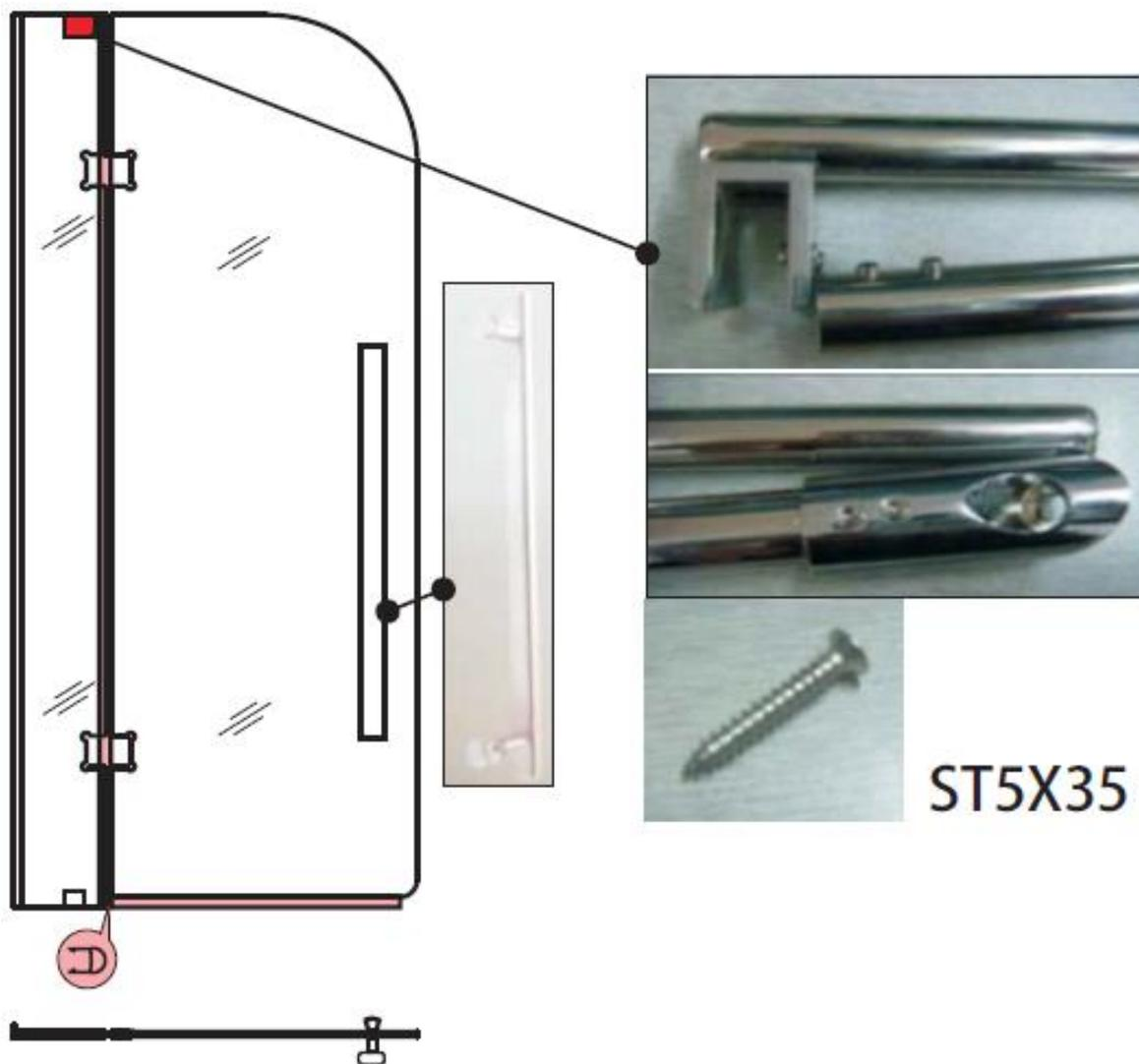
**D**Installare le cerniere della porta. Avvitare il
