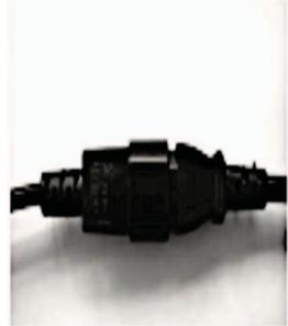
15. Tutti i fili del pannello superiore sono ora collegati ai connettori corrispondenti dei componenti elettrici, come ixix, ionizzazione dell'ossigeno, ecc. La sauna non funzionerà correttamente se i connettori sono amati o non collegati.
