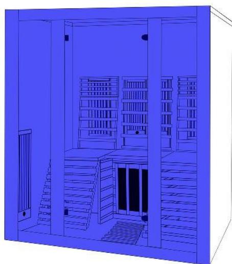
(13) Instalace předního panelu do levého a pravého
