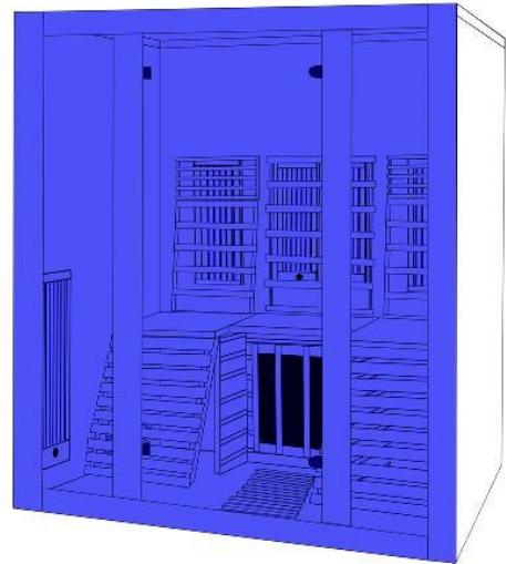
(13) Inštalácia predného panela do ľavého a pravého panela
