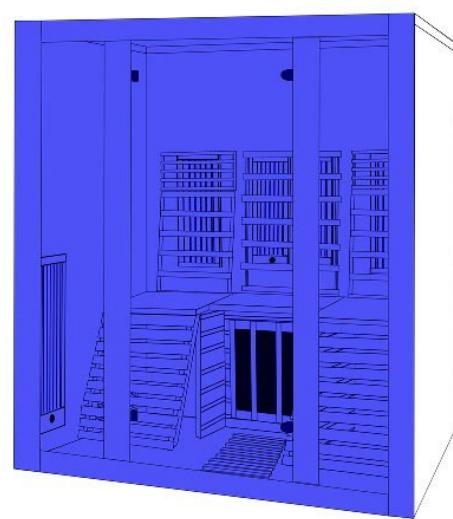
(12) Instalați spătarele pe panoul din spate cu șurub M3.5 \* 40.
