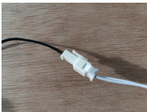
(3) priključite konektore temperaturnega senzora
