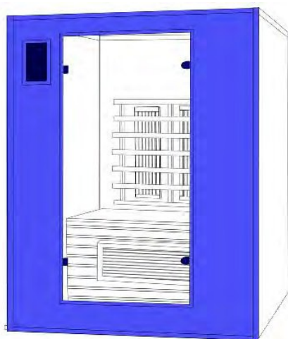
(8) Állítsa a padlólapra a frontlapot és az előszerelt csatok segítségével kapcsolja össze az oldalfalakkal.
