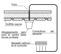
Il cavi per il limitatore (bianchi) e il sensore della temperatura (rosso) vanno fissati alla scheda del sensore secondo la fig. riportata sotto. Successivamente fare scattare in posizione la scheda del sensore nell'alloggiamento.
