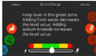
*Quando si esegue un test, l'indicatore BromiCharge™ indica il livello approssimativo bromuro di sodio della spa.*
