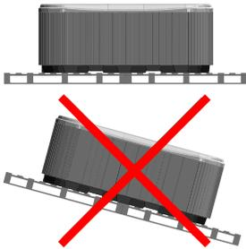
Una solida base orizzontale, è necessaria per l'installazione della spa. Si consiglia di utilizzare una fondazione in cemento armato almeno 10-15cm di spessore.
