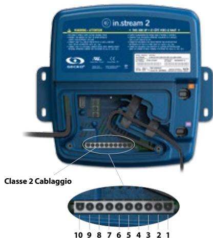
Gli altoparlanti ed i terminali di uscita del subwoofer si trovano sul connettore MATE-N-LOK 10-pin marcata "SUB R-R R-L F-R F-L"
